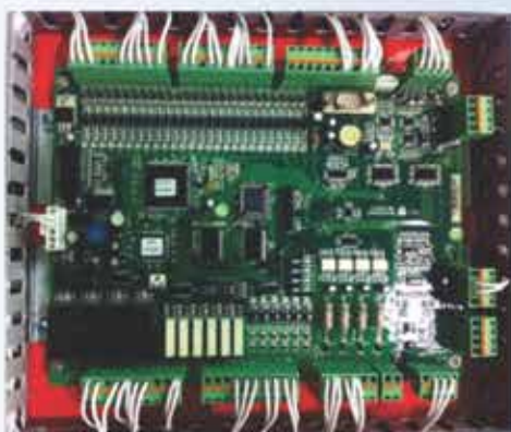
Bộ vi xử lý STEP (Loại thể hệ mới dùng cho thang tốc độ cao từ 80m/p trở lên)
